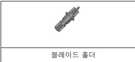
블레이드의 길이를 조정하고 커팅할 때 블레이드 홀더의 캡이 소재에 마찰되어 캡의 끝부분이 점차 마모된다. 캡이 점점 마모되면서 블레이드 끝부분을 올바르게 조절할 수 없게 되고, 그렇게 되면 깨끗한 커팅이 불가능하다. 이런 경우 새 블레이드 홀더로 교체한다. 블레이드 홀더를 오래 사용하면 블레이드를 지지하는 베어링이 노후되어 블레이드가 회전하기 어려워진다. 이렇게 손상된 블레이드 홀더를 계속 사용하면 블레이드 끝이 부드럽게 돌지 않아 깨끗하게 커팅되지 않는다. 코너나 곡선 부분이 깨끗하게 커팅되지 않았거나, 커팅 부위가 구멍이 뚫린 선처럼 보이기 시작하는 증상 등 유사한 문제가 발생하는 경우 P. 168 "블레이드 홀더 캡 청소" 를 참조하여 블레이드 홀더 캡을 청소한다. 문제가 해결되지 않으면 새 블레이드 홀더로 교체한다.
