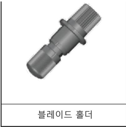
블레이드 끝부분이 조정된 후(마모되어 짧아지거나 길이를 너무 짧게 조정 하여 사용하는 경우) 커팅 시 칼날 홀더의 캡이 소재에 마찰되어 점차 마모된다. 캡이 점점 마모되면서 블레이드 끝을 올바르게 조정할 수 없게 되고, 깨끗한 커팅이 불가능해진다. 이런 경우 블레이드 홀더를 교체한다. 블레이드 홀더를 오래 사용하면 블레이드를 지탱하는 베어링이 나빠져 블레이드가 회전하기 어려워진다. 손상된 블레이드 홀더를 계속 사용하면 칼날 끝이 매끄럽게 돌아가지 않기 때문에 깨끗하게 커팅되지 않는다. 모서리나 곡선 부분이 깨끗하게 절단되지 않았거나 커팅된 부분이 구멍이 뚫린 선처럼 보이기 시작하거나 유사한 문제가 발생할 경우 "[Cleaning the Blade Holder Cap](#)" 를 참조하여 블레이드 홀더 캡을 청소한다. 이렇게 해도 문제가 해결되지 않으면 블레이드 홀더를 새것으로 교체한다.
